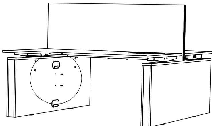
Ta bort täckhattarna ur hålen under kabelgenomföringen på benboxarna och sätt i systemskruvarna.
