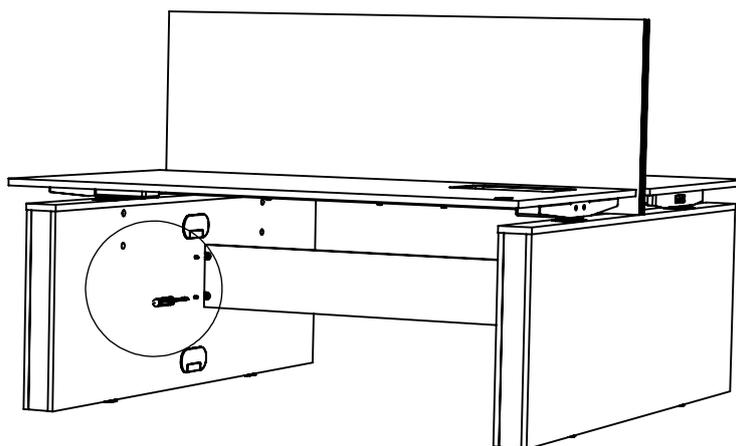
Skjut på panelen på skruvarna och skruva åt beslagen.
